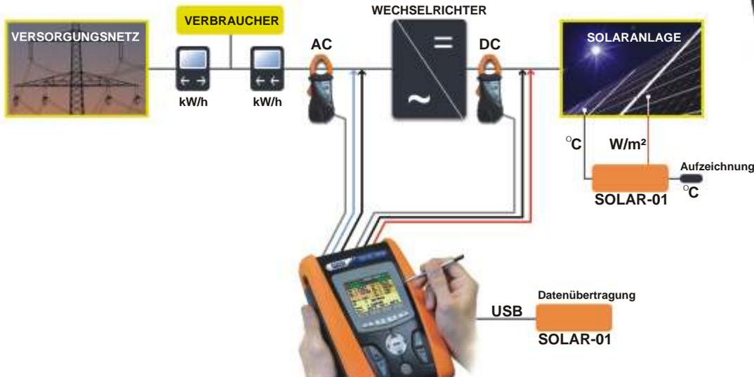
Messung des Wirkungsgrades der Anlage und Netzanalyse
